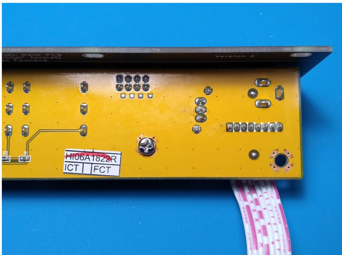
Les nappes de liaison d'origine étant courtes, si vous souhaitez déporter l'extension, vous pouvez utiliser les rallonges fournies (50 cm). Connectez les aux connecteurs X21 (8 fils) & X22 (2 fils)...
