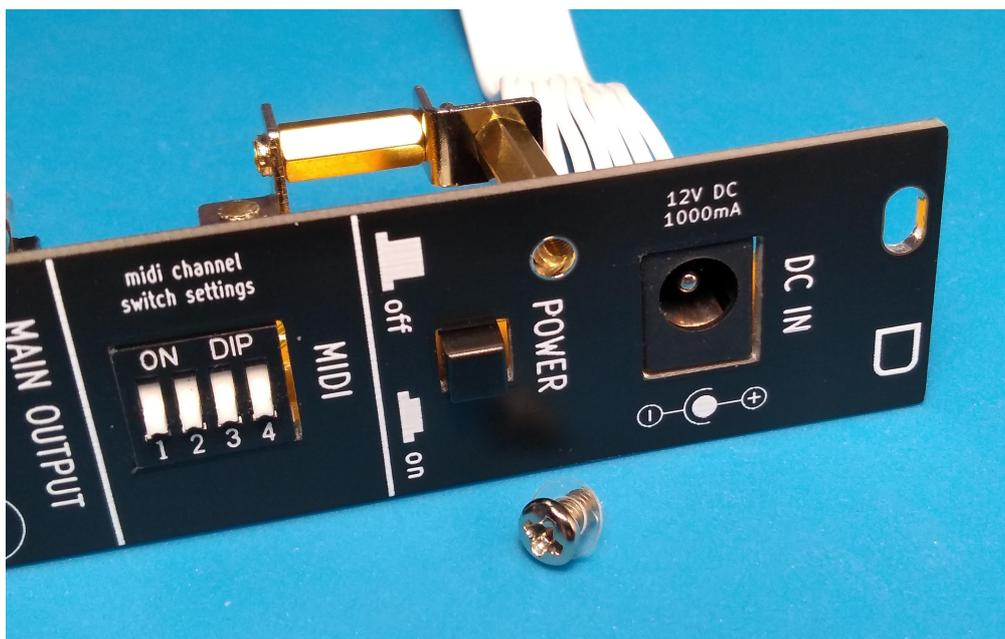
Vérifier la bonne correspondance avec le trou du système d'équerres ; placer la vis (avec rondelles nylon) et l'écrou hexagonal dans leur logement respectif... replacer les écrous des Jacks OUTPUT. Vous pouvez les serrer de manière définitive.
