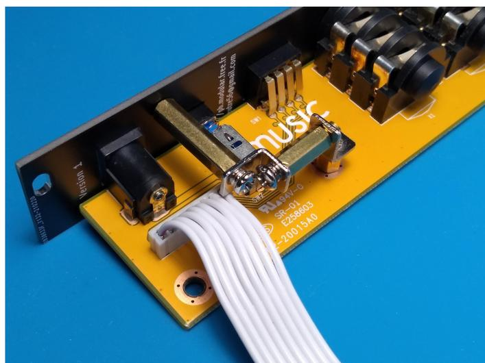
Retourner l'ensemble et resserrer la vis du système d'équerres.
