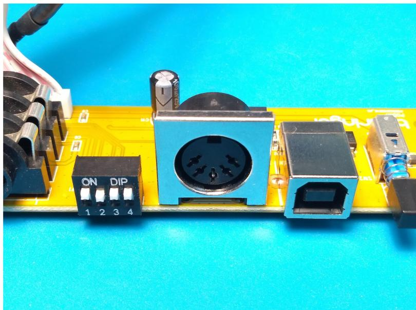
Repérer les 7 points de soudure du socle DIN...
