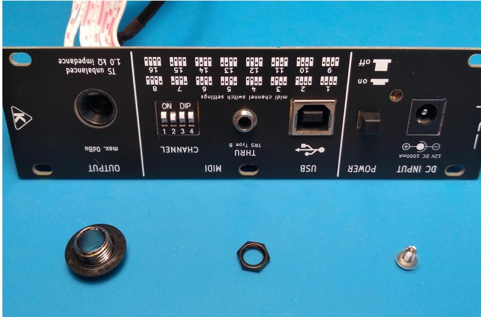
Vérifier la bonne correspondance du trou du système d'équerre ; placer la vis (avec rondelle nylon) et l'écrou hexagonal dans leur logement respectif... replacer l'écrou du Jack OUTPUT. Vous pouvez les serrer de manière définitive.
